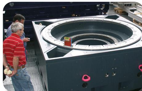
**EBENHEITSMESSUNG AN DER KREISFÖRMIGEN AUFLAGE
